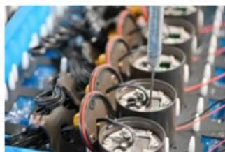
机械手臂灌胶机安装在 1050 线、1061 线，和烘干炉 แนวหุ่นยนต์หยอดการอัดโม่ติดตั้งที่ไลน์ 1050 、 1061 และเครื่องอบความร้อน
