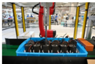
机械手臂灌胶机安装在 1050 线、1061 线，和烘干炉 แนวหุ่นยนต์หยอดการอัดโม่ติดตั้งที่ไลน์ 1050 、 1061 และเครื่องอบความร้อน
