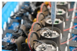
机械手臂灌胶机安装在 1050 线、1061 线，和烘干炉
